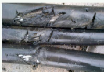
Figura 27: Danos superficiais dos condutores observados na Indonésia
