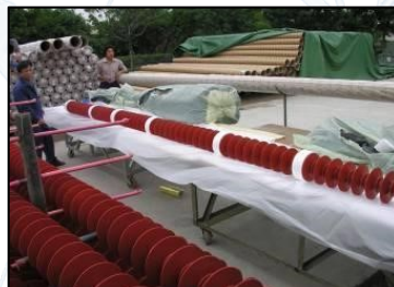
Figura: Alternativas de métodos corretos de reembalagem dos isoladores compostos para transporte em obra.
