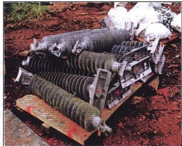
Figura: Métodos impróprios de reembalagem e armazenagem de isoladores compostos.
