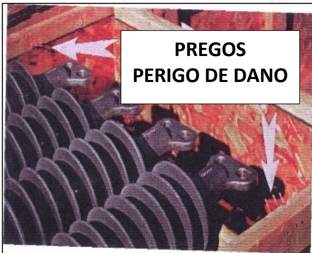
Figura: Métodos impróprios de reembalagem e armazenagem de isoladores compostos.
