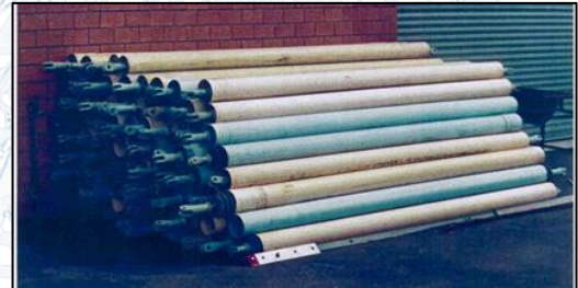
Figura: Alternativas de métodos corretos de reembalagem dos isoladores compostos para transporte em obra.
