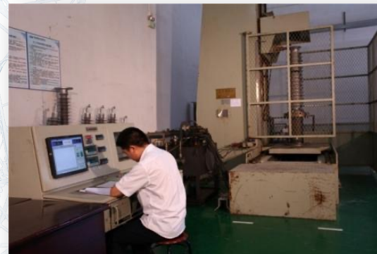
Máquina de Torção e Flexão 25 kN, h=5.5 m
