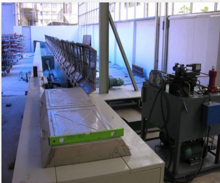
Máquina de Ensaio Termomecânico (2.200 kN, 15 m)
