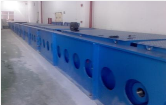
A maior Máquina de Ruptura a Tração (3.000 kN, 29 m)
