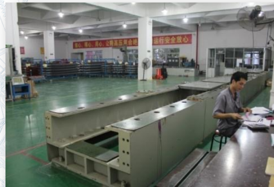
Máquina de Ruptura a Tração (1.000 kN, 10m)
