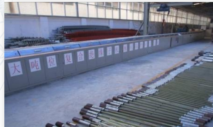
Ensaio mecânico ( 80% da carga e ruptura por 96 horas )
