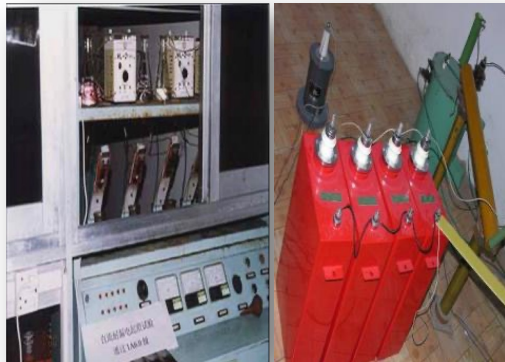
Teste de Trilhamento e Erosão
