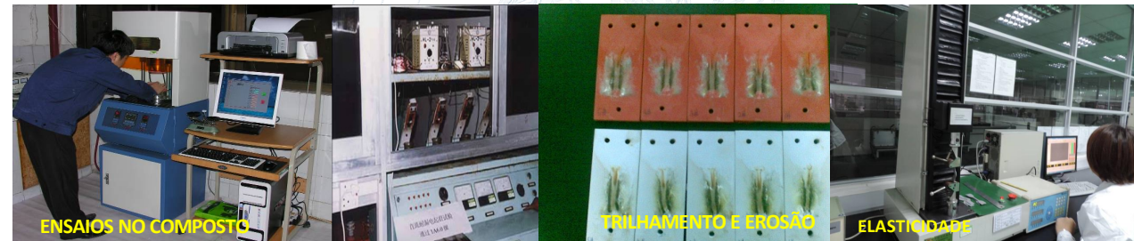
Inspeção da Borracha de Silicone
